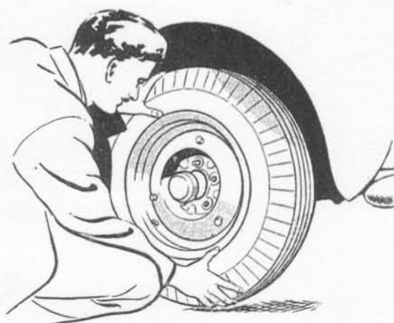
Fig. 32.—ENTERED STUD AT TOP.
